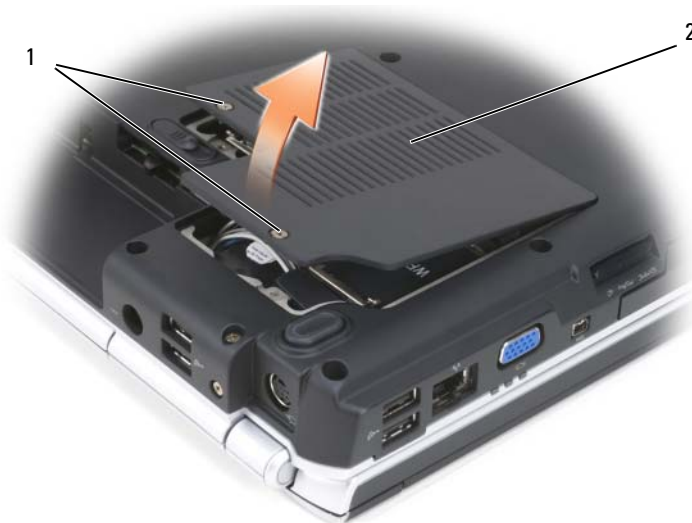
1 viti di fissaggio (2) 2 coperchio
